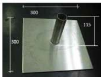
Metalliputken halkaisija 44 mm.
