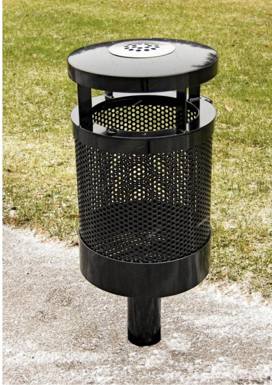
Poubelle de taille moyenne avec cendrier dans le couvercle. Cette poubelle de 55 litres intègre un cendrier dans le couvercle. Le réservoir du cendrier se fixe par dessous et se vide facilement. Cette poubelle se fixe dans des fondations coulées avec son poteau central (108 mm) ou avec une plaque de fixation.
