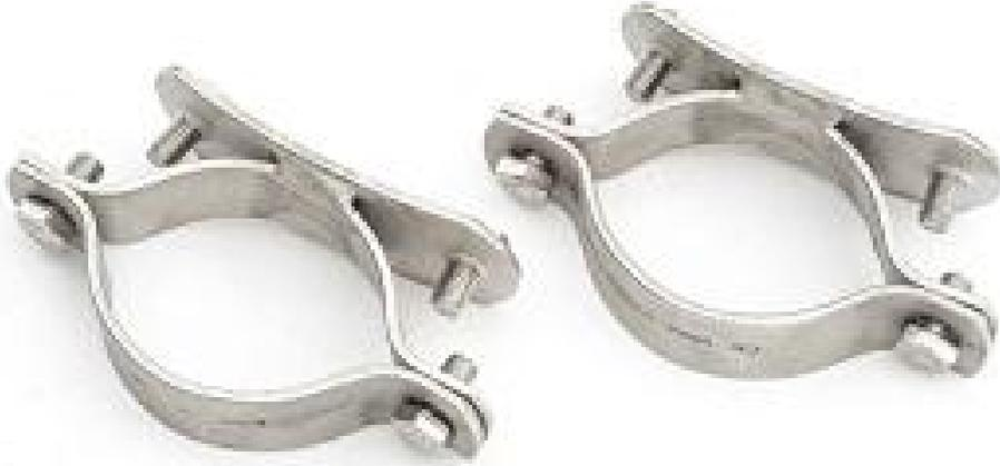
Colliers de serrage en acier inoxydable adaptés à différents types de poteaux de 60 à 220 mm de diamètres (poteaux de signalisation, lampadaires, etc.). Deux colliers sont nécessaires pour les poubelles de 30 et 60 litres. Le numéro de produit CT-F01 convient aux poteaux de 60 mm. Pour les poteaux plus gros, choisissez : CT-F02 (75-85 mm), CT-F03 (90-105 mm), CT-F04 (105-120 mm), CT-F05 (130-150 mm), CT-F06 (155-170 mm), CT-F07 (170 -180 mm), CT-F08 (200-220 mm).
