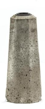
Fondation enterrée en béton pour poteau de 60 mm de diamètre. La fondation en béton est coulée dans un trou de 500 mm de profondeur, puis recouverte de terre et comprimée soigneusement.
