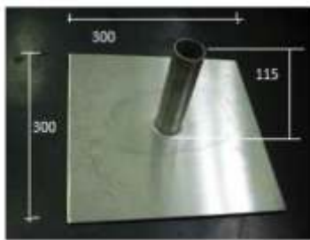
Metalliputken halkaisija 44 mm.
